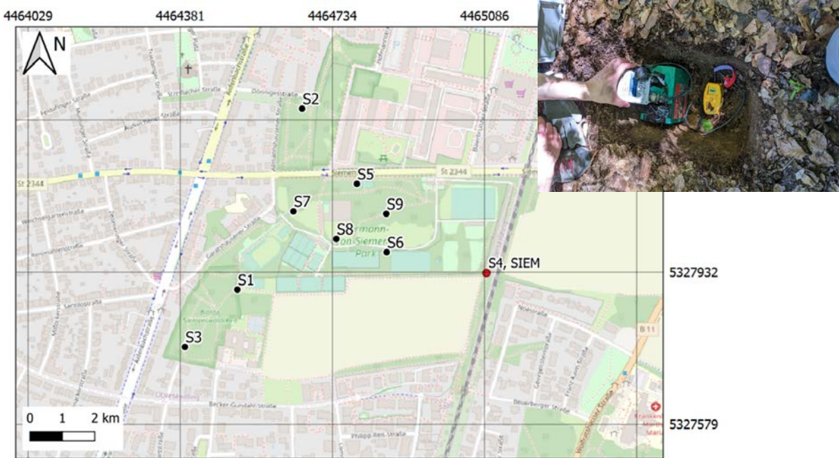
Abbildung 7: Layout des Mini-Array im Siemenspark mit Beispiel einer Messstelle.
